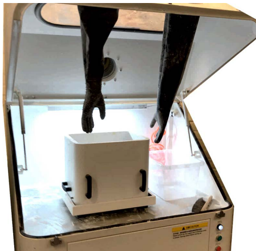
Figura 8 : Caja de traslado colocada dentro de la cámara de la estación de recuperación de polvo
